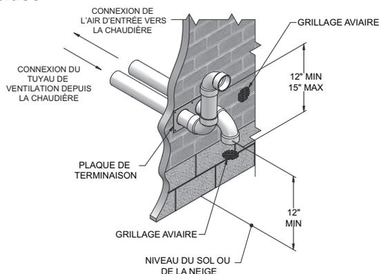
3. La tuyauterie d'air doit se terminer sur un coude tourné vers le bas, comme indiqué à la FIG. 4-1A. Cette disposition empêche toute recirculation des produits de combustion dans le courant d'air de combustion.
