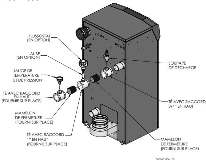
**Figure 6-2** Pose du flussostat, de la soupape de décharge et de la jauge de température et de pression\_Modèles 725 – 1000
