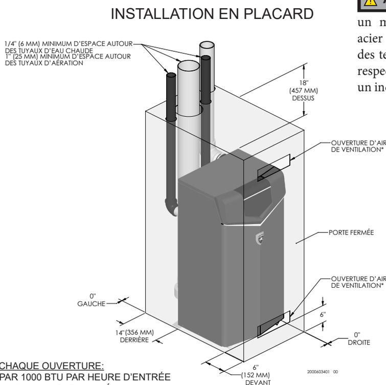
**AVERTISSEMENT** Pour les installations en placard, un matériel de ventilation en CPVC ou en acier inoxydable DOIT ÊTRE utilisé en raison des températures élevées. Tout manquement au respect de cet avertissement pourrait provoquer un incendie, des blessures corporelles ou la mort.
